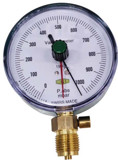
Kuva 6.22 Mekaaninen tyhjiömittari, jossa yksi viivanväli vastaa 1000 Pa.
