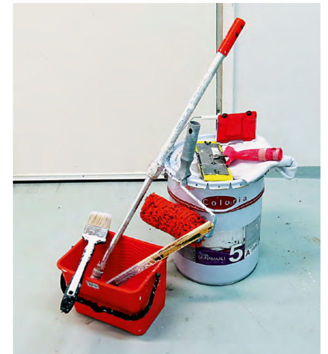
8.23 Seinän maalaukseen tarvittavia työvälineitä: akrylaattimaalia, tela ja telavarsi, patterisivellin, telakaukalo, rajaaja, hiomatuki ja sekoitustikku.
