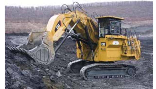
Kuva 10.6 Pistokauhalla varustettu kaivinkone.
