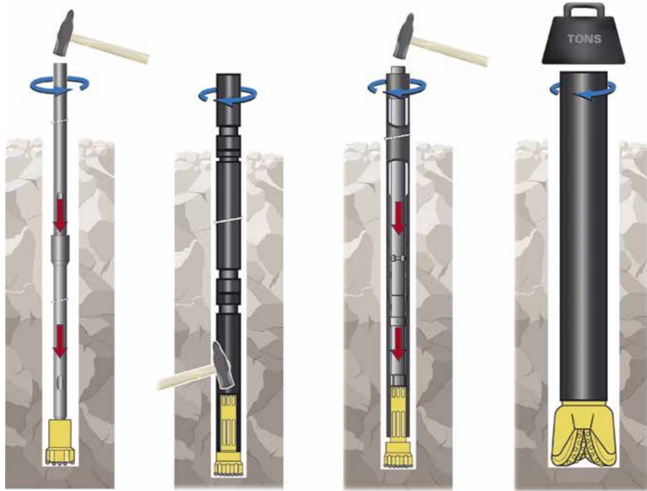
Kuva 8.2 Porausmenetelmät vasemmalta oikealle: iskuporaus, uppororaus, iskuporaus putki- tankokalustolla ja kiertoporaus.
