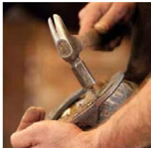
Takakavion naulaus. Huomaa käden tuki ja paikka naulojen etupuolella: jos hevonen vetää jalan pois, nailat eivät revä kättä.
