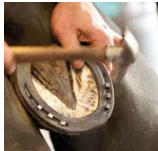
Nailat on lyöty paikalleen. Tehdaskenkien viimeinen naulanreikä on yleensä liian takana ja niitä käytetään vain, mikäli seinämässä on lohkeamia.
