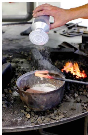
Kuva 3.11 Booraksia tarvitaan, mutta sen liikakäyttö johtaa ongelmiin. Metallinen maustesirotin on mainio apu tässä vaiheessa.
