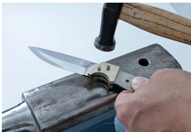
Kuva 2.13 Helapalat niitataan lyömällä kevyesti niittien päitä sen verran, että niittien päät tyssääntyvät paksummiksi.
