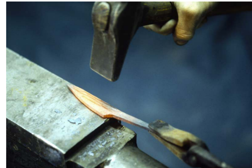
Kuva 1.9 Terän levitys tapahtuu kätevästi alasimen selkäosalla sarven puoleisessa etukulmassa. Huomaa sijainti aivan alasimen reunalla. Taonta tapahtuu keltakuumassa.
