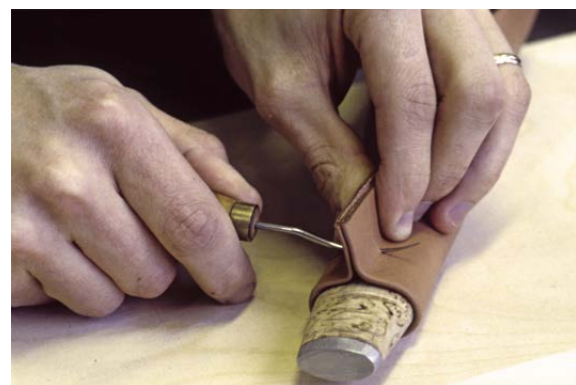
Kuva 1.31 Lävistys messinkilenkkiä varten onnistuu naskalilla.
