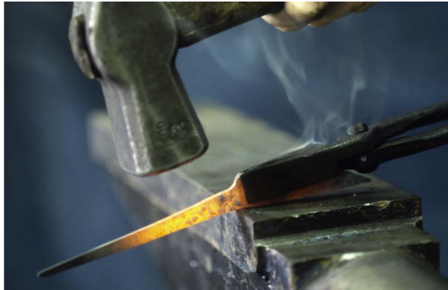
Kuva 1.8 Ruotoa esitaivutetaan alaspäin. Terän suun takominen nostaa ruotoa ylöspäin.
