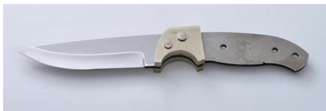
Kuva 2.14 Puukko käännetään ympäri ja vastakkaisen puolen päät niitataan loppuun.
