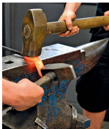
Kuva 3.10 Kuvan asetelmalla aihio voidaan taittaa täsmällisesti rasittamatta liikaa varren hitsausaamaa.
